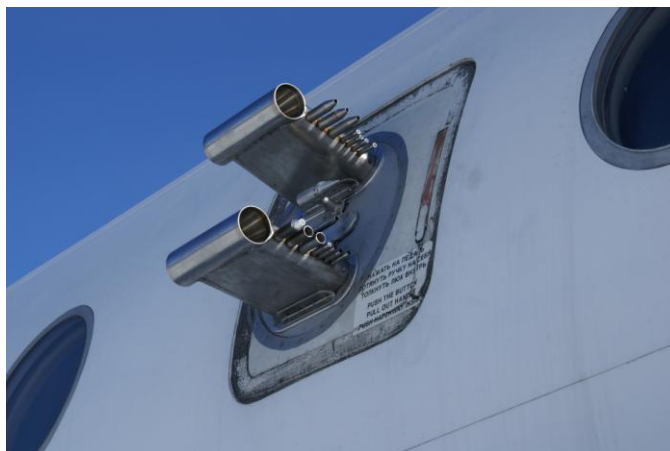
Одни из заборников воздуха на обшивке Ту-134
