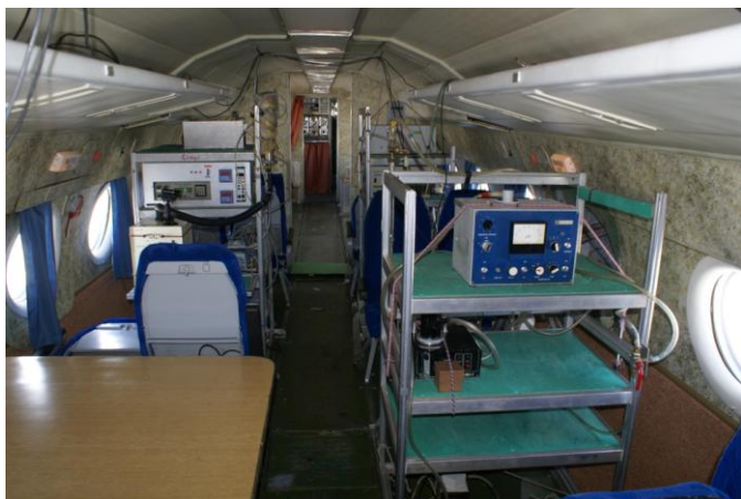
Размещение оборудования внутри самолета-лаборатории
