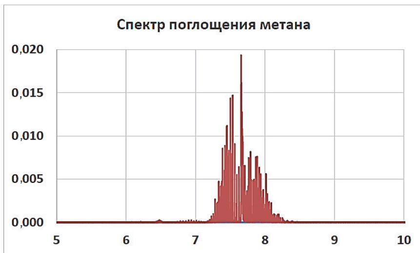
Рисунок 6.7 - Коэффициент поглощения метана: по оси абсцисс – длина волны (мкм); по оси ординат – коэффициент поглощения ( \text{ppb}^{-1}\text{см}^{-1} ).
