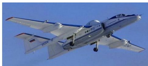
Рис. 3 Высотный российский самолет лаборатории М55 "Геофизика".
