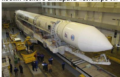
Ракета космического назначения «Зенит-2СБ» с разгонным блоком «Фрегат-СБ» и российским метеорологическим космическим аппаратом «Электро-Л», фото с сайта: www.meteorf.ru
